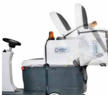
La possibilité de pouvoir faire basculer complètement le réservoir de récupération permet d'accéder facilement au compartiment de la batterie et au système Ecoflex
